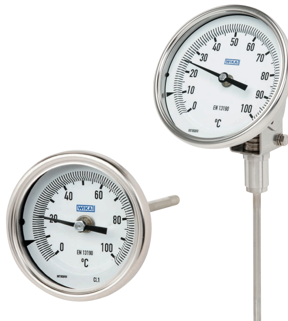
Abb. links: Anschlusslage rückseitig (axial) Abb. rechts: Anschlusslage rückseitig, dreh- und schwenkbar
